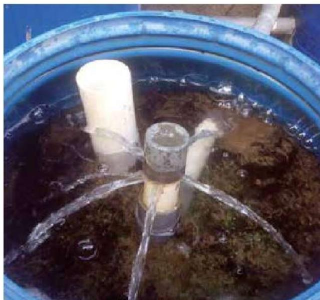
Gambar 2. Proses Filtrasi dengan media Pasir Silika dan Granular Activated Carbon pada WTP Mini Generasi 1
